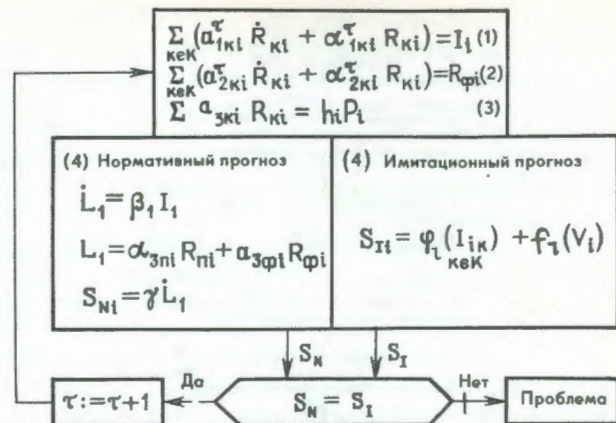
Рис. 1.8. Выявление проблем путем сопоставления нормативного и имитационного прогнозов ( I_i = I_{ni} + I_{\Phi i} )
